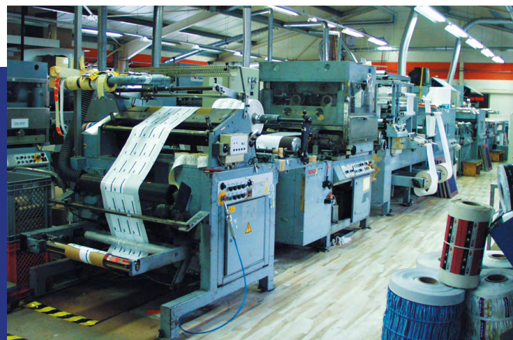
Auf dieser Rollensiebdruckmaschine von 1978 wurden insbesondere säurebeständige Etiketten für Batteriehersteller produziert.
